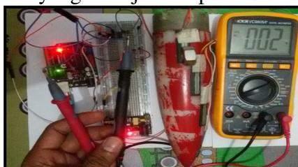
Gambar 16. Pengujian Tegangan Keluaran IC LM358
