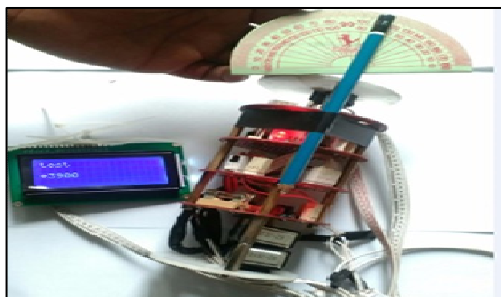
Gambar 11. Hasil pengujian Mikrokontroller Atmega8 dengan Sensor Accelerometer
