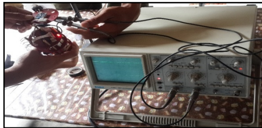
Gambar 9. Pengujian Sensor Accelerometer dengan Oscilloscope
