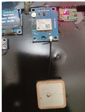
**Gambar 17.** Pengujian Sensor GPS Ublo Neo-6M
