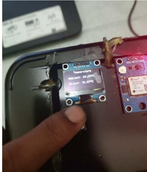
**Gambar 12.** Pengujian Sensor Suhu MLX90614
