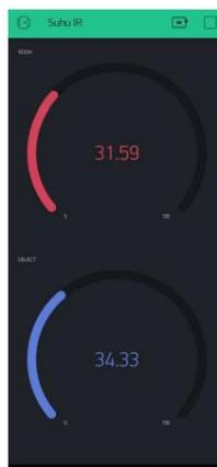
**Gambar 11.** Tampilan Hasil Sensor Suhu MLX90614 pada Blynk
