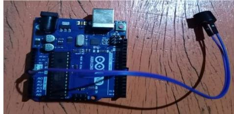
**Gambar 4.** Rangkaian *Buzzer* ke *Mikrokontroler*
