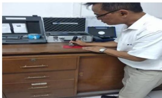
**Gambar 5.** Pengujian Daya Lekat (*cross cut*)
