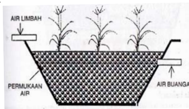
Gambar 5. Tipe Aliran Air Bawah Tanah
