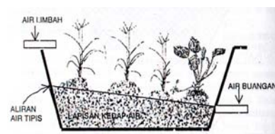
Gambar 7. Tipe Hidroponik Aliran Tipis
