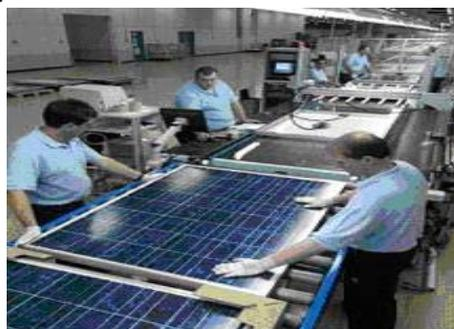
Gambar 3. Fabrikasi *Photovoltaic*
