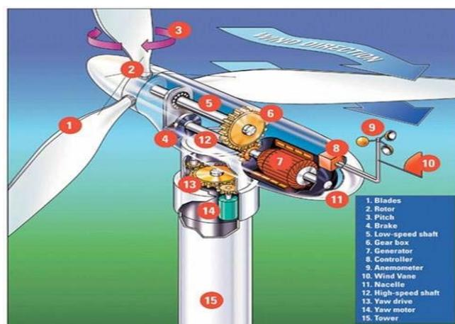
Gambar 8. Konstruksi *Wind Power*
